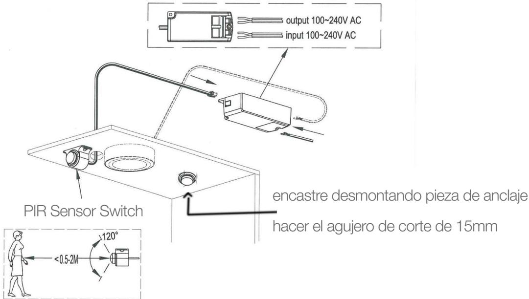
Esquema de conexión:
