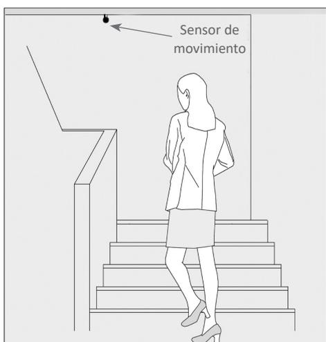
Sin detectar movimiento: LUZ APAGADA      Detectando movimiento: LUZ ENCENDIDA
